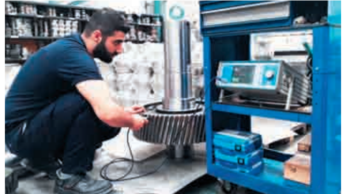
Ultrasonik Diş Yüzeyi Sertlik Derinliği Homojenliği Ölçüm Cihazı Ultrasonically Hardness Depth Homogeneity Measurement Device on Tooth Flank
